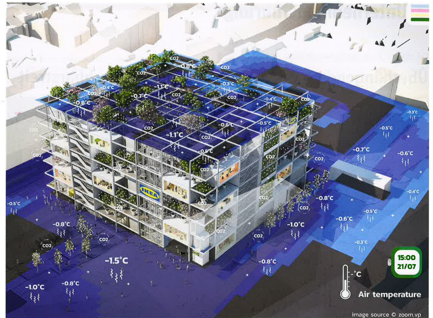
11. Ikea Westbahnhof Wien – Kühlleistung von bis zu 1.5°C Lufttemperatur an einem Hitzetag.
