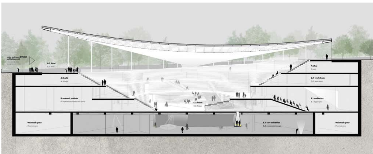
Das Gebäude ist zum überwiegenden Teil ins Gelände eingebettet. Der Weg führt vom dunklen Ausstellungsraum über eine sich nach oben weitende Rampe, die im lichtdurchfluteten „demokratischen Raum“ der Agora mündet. © querkraft
